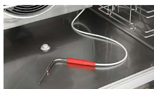
Sonda de controle no coração do alimento.
