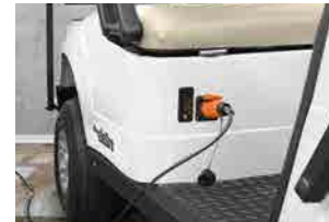
As baterias podem ser recarregadas em qualquer tomada elétrica residencial, em redes 127 V ou 220 V.
