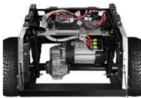
Motor elétrico a bateria, silencioso e com grande autonomia. 5 kW / 48V / 6,7 hp.
